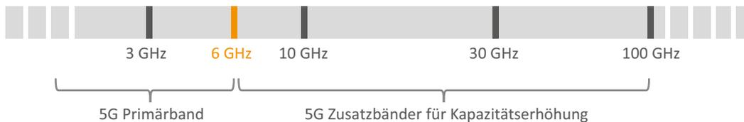
Abbildung 26: Erweiterung des Mobilfunkspektrums für 5G
